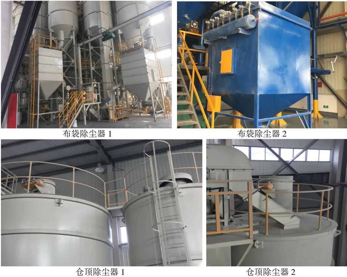
图 4.1.2-2 仓顶除尘器照片
